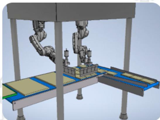
Applicazioni sia robotizzate che non per la bucatura e modellatura di pizze e focacce, composte da Robot Delta, struttura di tenuta e trasportatore di trasferimento.
