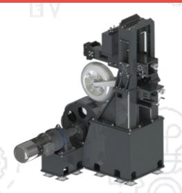
La soluzione si compone di una cabinato con all'interno un **banco di collaudo** tramite il quale viene riprodotta la velocità che il pneumatico dovrà sopportare in strada.
